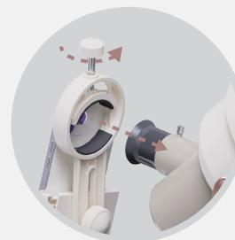
3 Setze die Okularklammer auf das Okular am Teleskop und drehe den Okularknopf gegen den Uhrzeigersinn fest. Bringe die Smartphone Halterung am Okular an.
