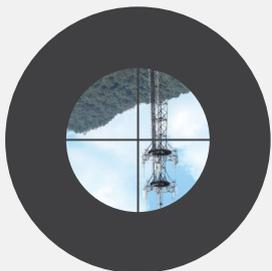
**3** Wenn du durch das Sternsucher-Objektiv schaust und die Mitte des Fadenkreuzes im Bild, nicht mit deinem Ziel übereinstimmt: Dann drehe das Ende des Suchers solange, bis das Bild fokussiert und mittig platziert ist.
