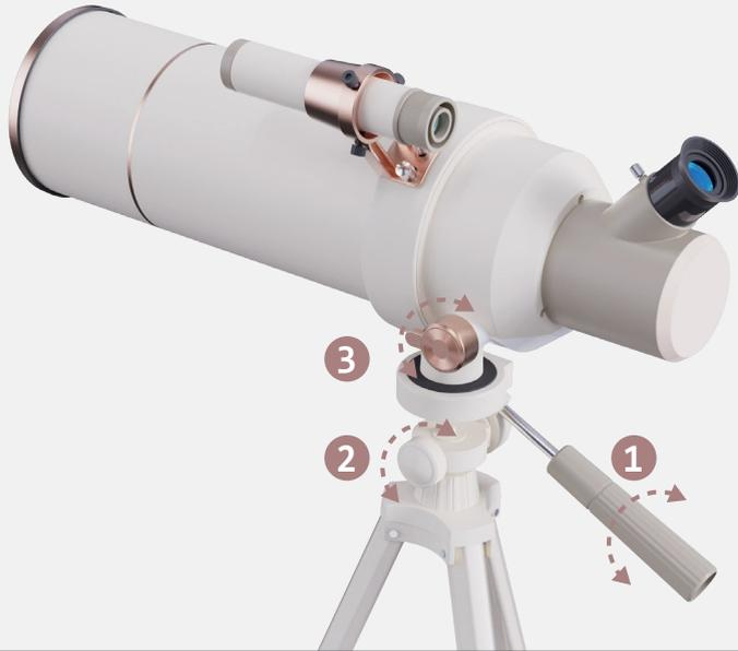
**1** Stelle den vertikalen Beobachtungswinkel des Teleskops über den Griff ein: Halte den Griff und drehe ihn gegen den Uhrzeigersinn, um den Winkel zu lösen. Bewege den Griff nach oben und unten und stelle so den gewünschten Beobachtungswinkel ein. Drehe den Griff dann im Uhrzeigersinn, um deinen vertikalen Beobachtungswinkel festzustellen.
