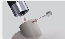
Setze das Okular in den optischen Tubus ein und schraube es mit einer 6-mm-Schraube fest. (10mm Okular, 25mm Okular und 3-fache Vergrößerungslinse können ausgetauscht werden). Hinweis: Setze das Okular nicht ein oder nimm es nicht heraus, wenn die Schraube eingedreht ist. Sonst wird das Okular beschädigt.
